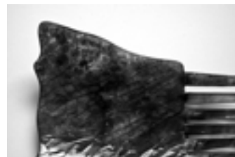
Foto 10. Craqueladuras en una peineta, producto de la degradación del nitrato de celulosa. Época: c. 1910, cat. 2004-241.
